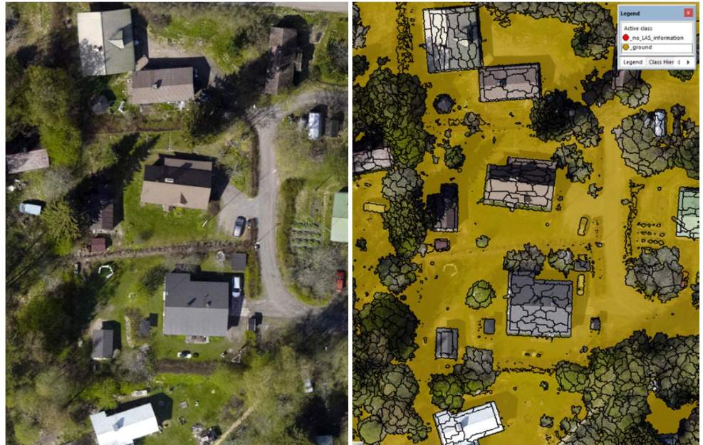
Kuva 4 Alkuperäinen ortokuva ja luokiteltu kuva, jossa maanpinnasta kohotetut kohteet on tunnistettu ja luokiteltu
