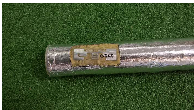
Smartrac anturin testaamista Parocin putkieristeellä
