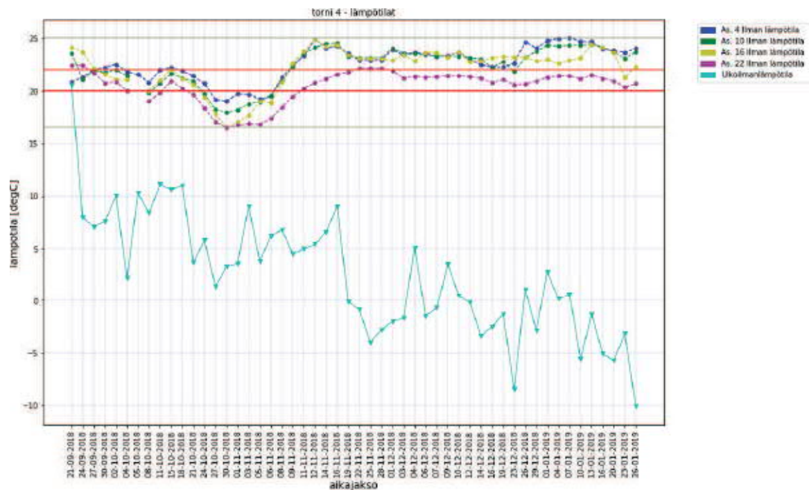
KUVIO 67. Rakennuksen 2. tomin 4. lämpötilat 24.9.2018 – 24.1.2019
