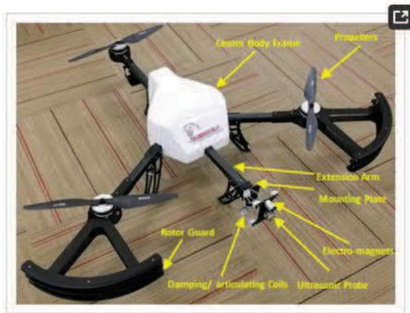
KUVIO 39. Lennokilla on suojat propelliensa ympärillä (Mattar ym., 2018, 1)
